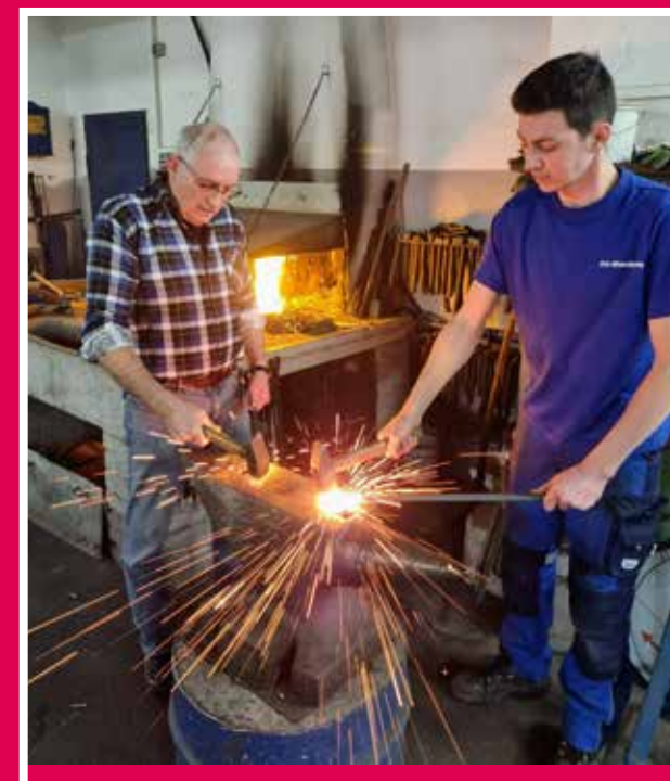
Seniorchef Horst Rehbein, Obermeister der Metallinnung Werra-Meißner-Kreis, zeigt Jan Pfordt aus Thurnhosbach, dem Auszubildenden im 2. Lehrjahr, die Handwerkskunst. Das Ausschmieden der Zierspitzen, welche für die Produktion benötigt werden.
